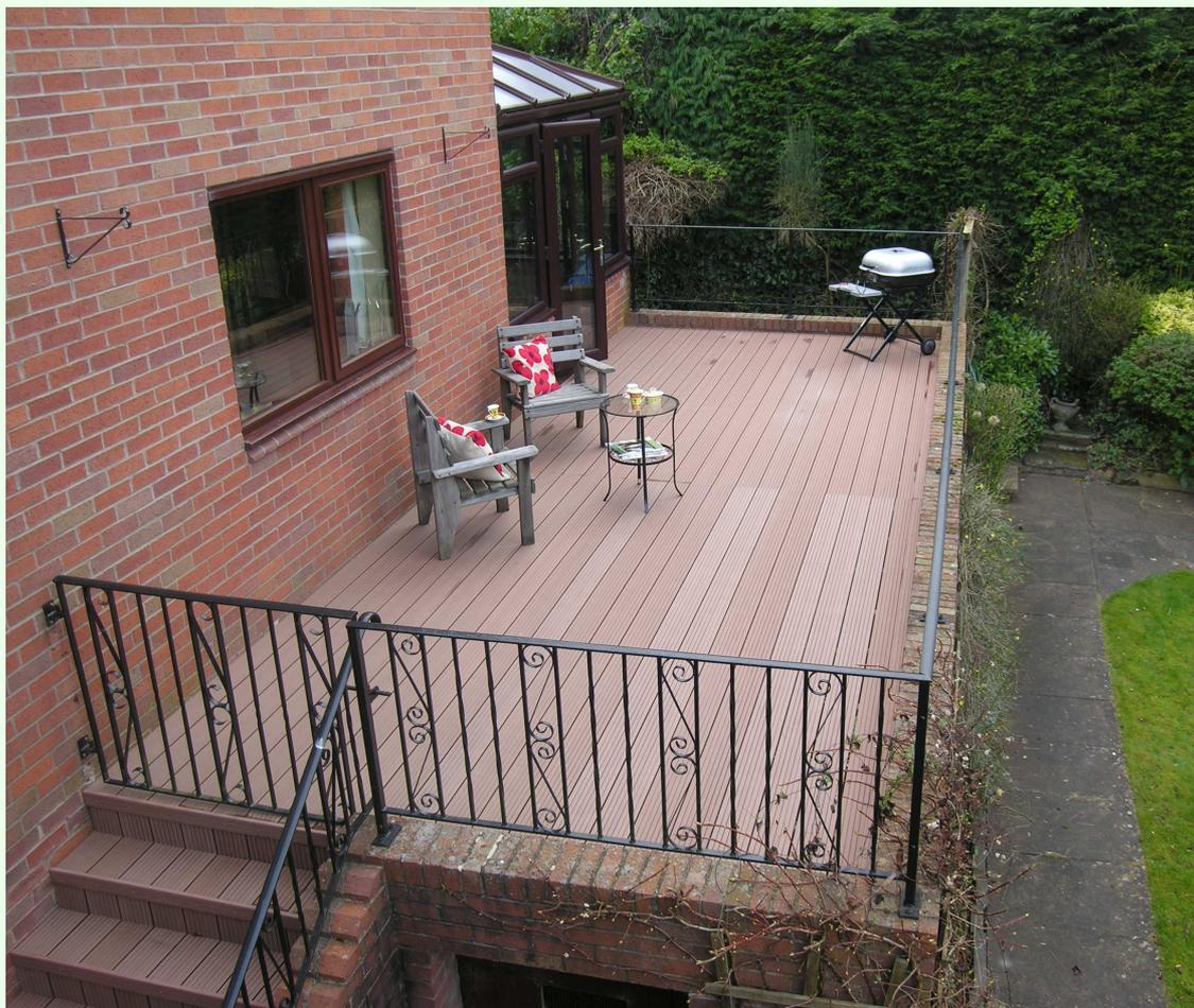
Fabriquée en Sologne dans notre usine de Bellegarde-du-Loiret, la planche Compo-Wood® a bénéficié de tous les soins et contrôles nécessaires. Composée de 50% farine de bois et de 50% résine, la planche est extrudée puis brossée soigneusement pour lui donner un toucher et une texture similaires au bois.
